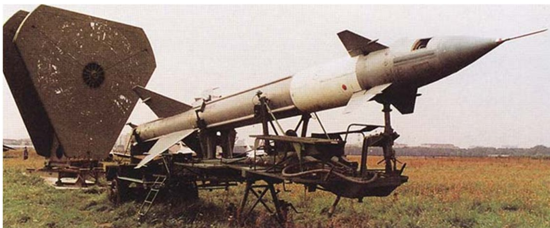
Obrázok 11 Riadená strela V-300 protiraketového systému S-25 Berkut (SA-1 GUILD)
