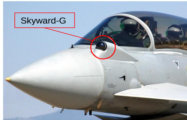
Obrázok 7 Gripen NG vybavený pasívnym infračerveným senzorom Skyward-G [7]
