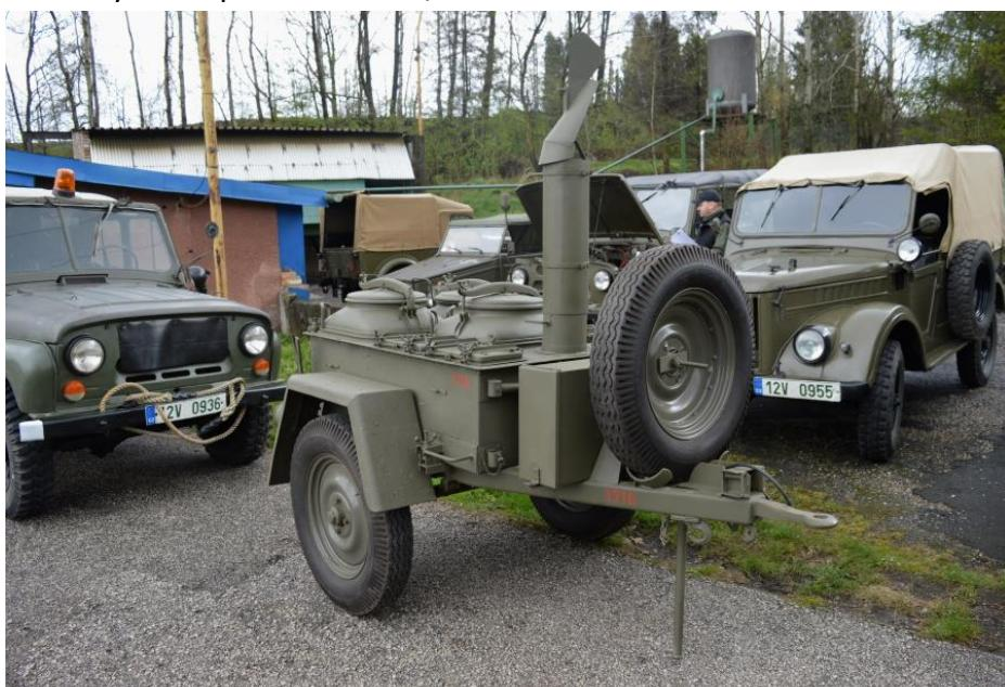
Obrázok 1 Poľná kuchyňa vzor 26
